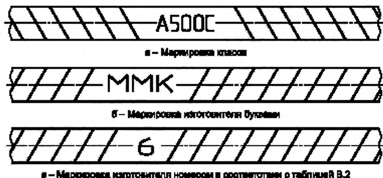
Рисунок В.1 — Маркировка проката надписью
