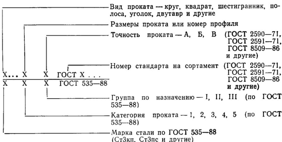
Прокат горячекатаный круглый диаметром 30 мм обычной точности прокатки (В) по ГОСТ 2590—71, марки Ст5пс, категории 1, группы II:
